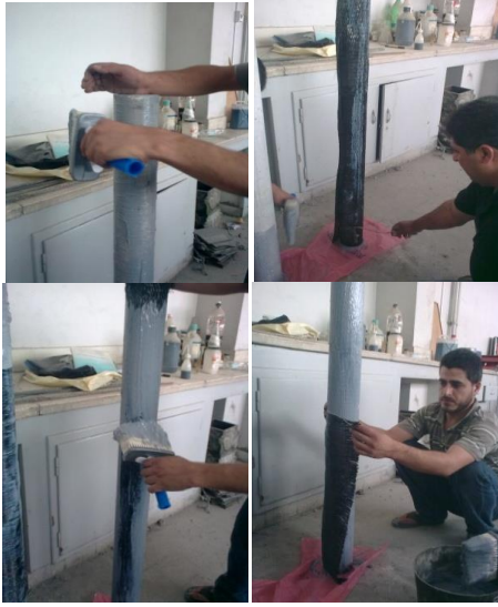
الشكل (7) مراحل التغليف بطبقة ألياف كربونية طولية و أخرى
