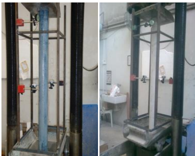
الشكل (8) مقاييس تشوه للعينات المختلفة.
