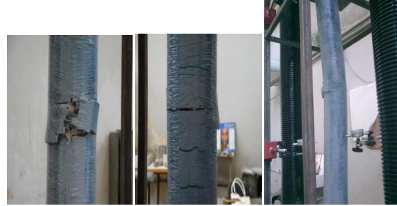
الشكل (11) انهيار المجموعة C1.
