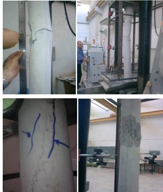
الشكل (9) انهيار العينات المرجعية.
